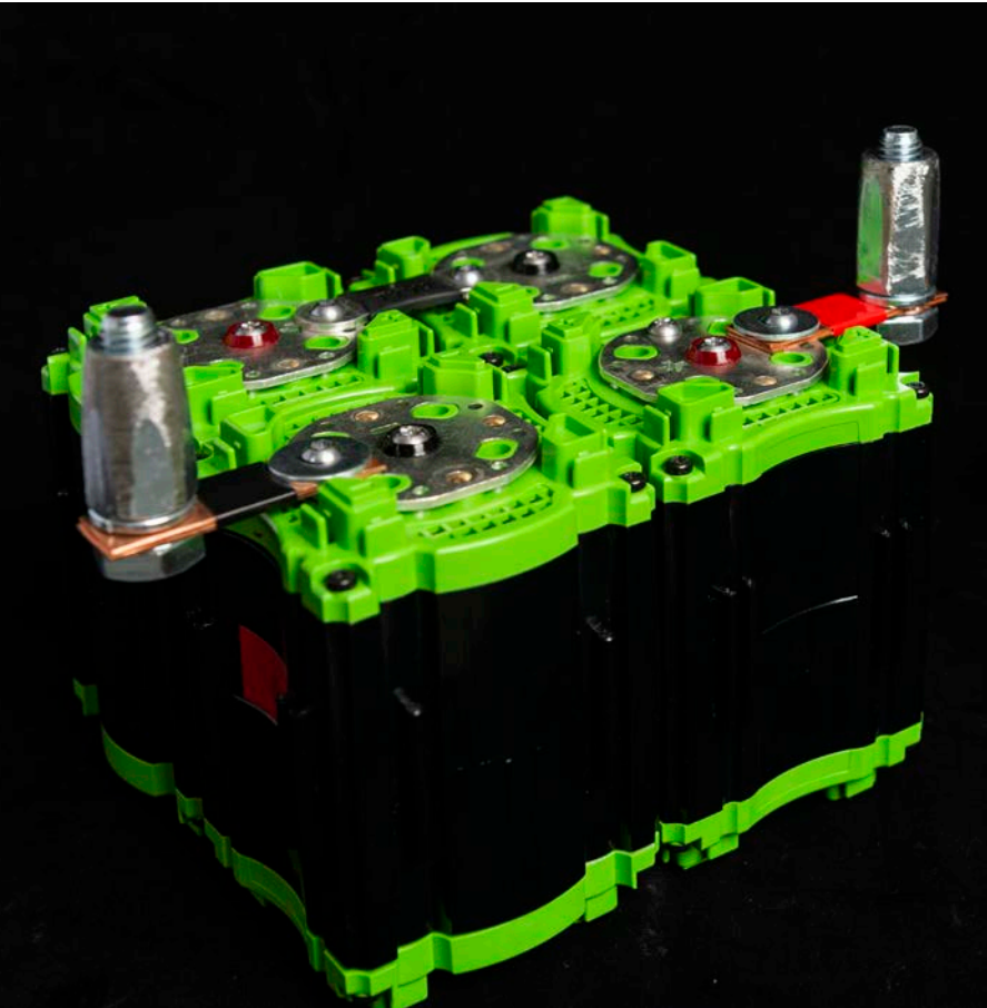
Pack de batterie pour starter de voitures thermiques fabriqué par Tiamat, une start-up du Réseau sur le stockage électrochimique de l'énergie (RS2E). © Cyril FRESILLON / Tiamat / CNRS Images
