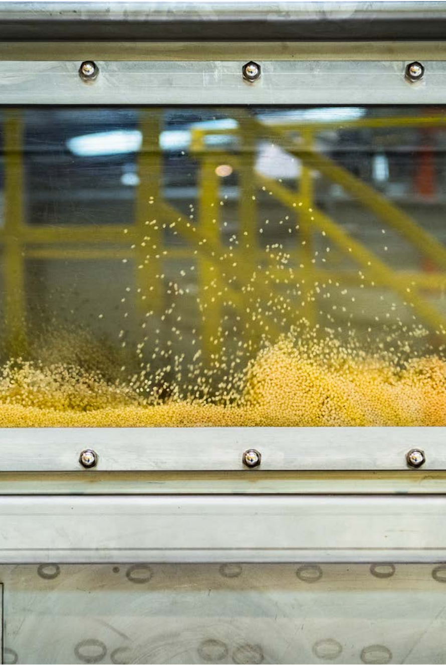
Granulés de CareTips® dans un lit fluidisé permettant leur séchage. CareTips® est un polymère naturel constituant une alternative à certains plastiques traditionnels, fabriqué par la société Lactips. © Cyril FRESILLON / IMP / Lactips / CNRS Images
