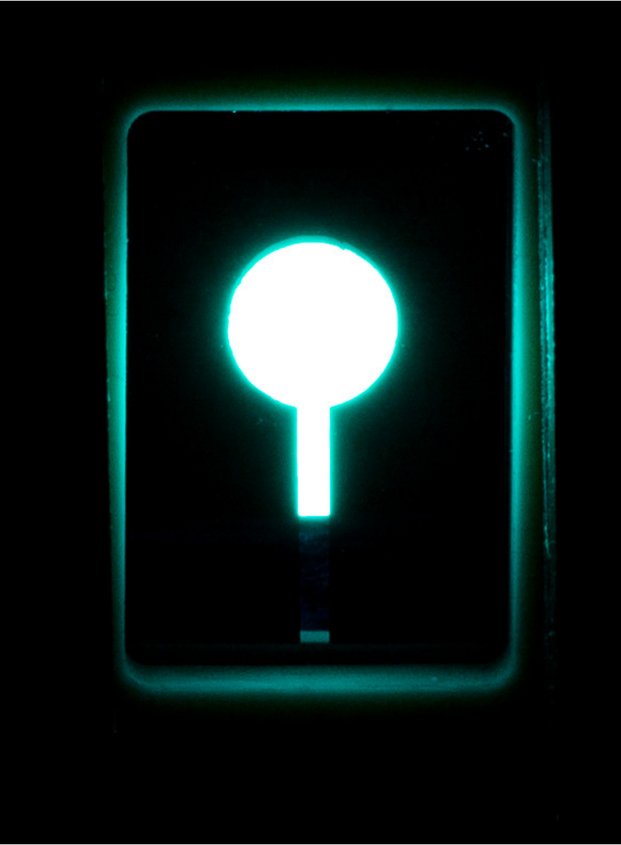
Diode électroluminescente organique DELo (OLED : Organic Light-Emitting Diode) développée au Laboratoire de physique des interfaces et des couches minces, en collaboration avec l'équipe MACSE de l'institut des sciences chimique de Rennes. © Jérémy BARANDE / LPICM / MaCSE / Ecole Polytechnique / CNRS Images
