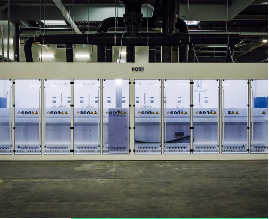
Le Wet-bench, machine robotisée permettant le traitement chimique du silicium issu d'anciens panneaux photovoltaïques usagés à l'usine ROSI Alpes. © Cyril FRESILLON / Simap / SOLAR / CNRS Images
