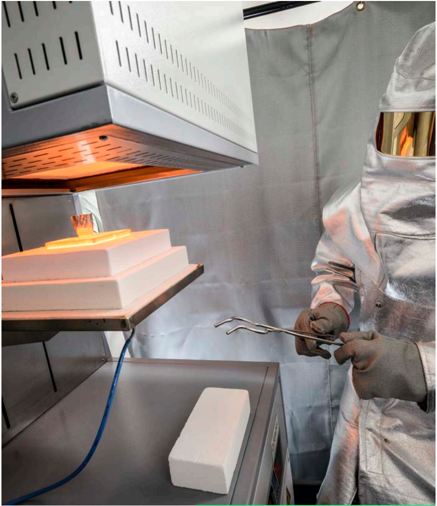
Panneau photovoltaïque après un passage au four dans l'usine ROSI Alpes. La cuisson permet de faire fondre son enveloppe plastique et ainsi de séparer les éléments qui le constituent. © Cyril FRESILLON / Simap / SOLAR / CNRS Images
