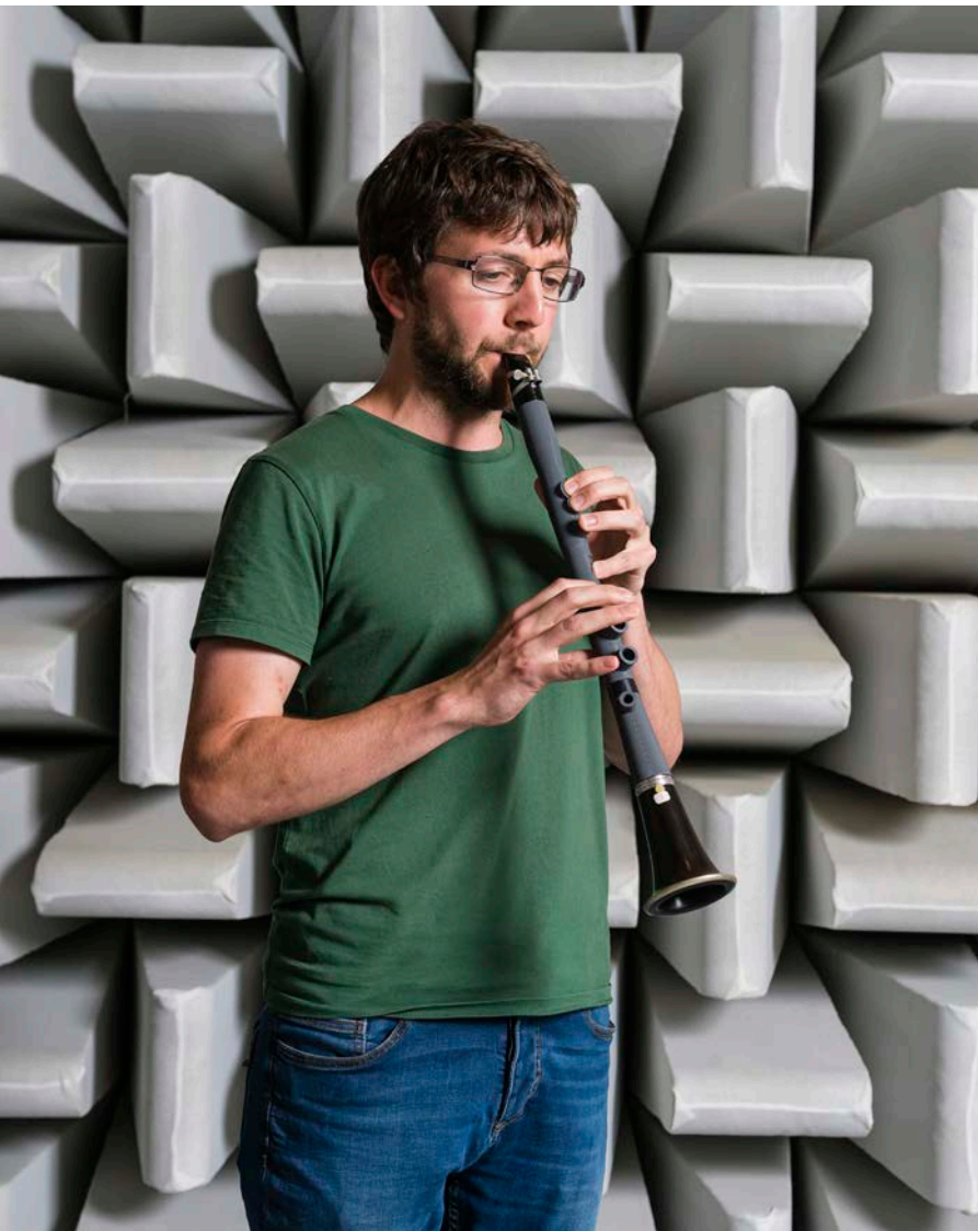
Prototype de clarinette testé en salle semi-anéchoïque. © Cyril FRESILLON / LMA / CNRS Images
